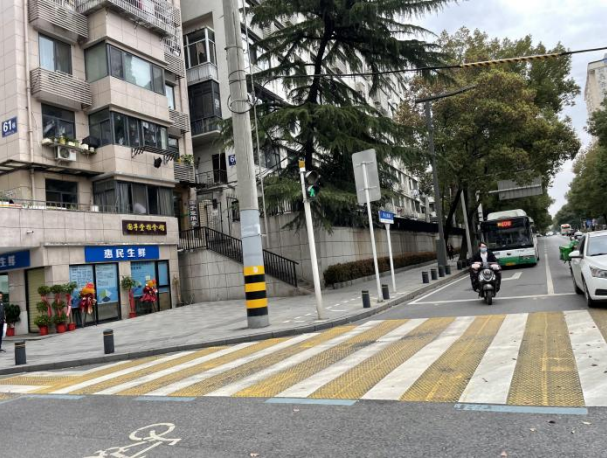
未设置无障碍坡道
