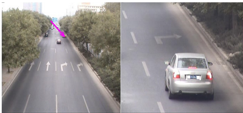
图 5-10 区域事件检测+球机抓拍违法停车过程。
